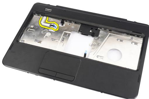
6. Drehen Sie die Handballenstütze um und entfernen Sie die Schraube, mit der die Betriebsschalterplatine an der Handballenstütze befestigt ist.
