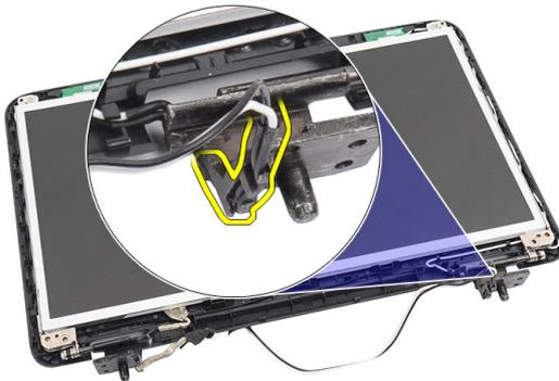
12. Lösen Sie das Bildschirmkabel aus dem linken Scharnier.
