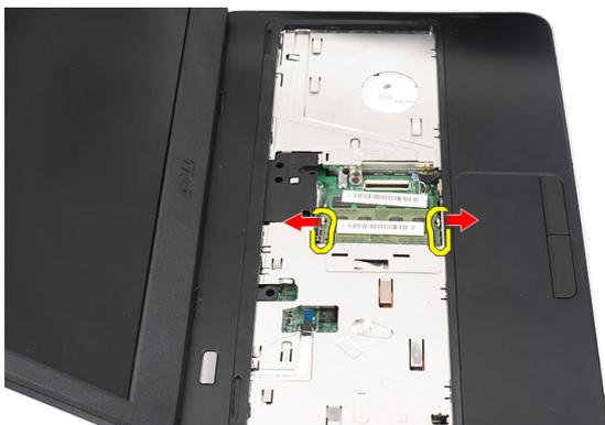
5. Entfernen Sie das Speichermodul aus dem Computer.
