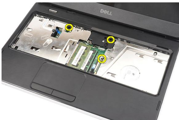
7. Hebeln Sie die Handballenstütze mit einem Stift aus Kunststoff nach oben und entriegeln Sie alle Schnappverschlüsse an der Unterseite sowie an der linken und rechten Seite der Handballenstütze. Sobald alle Schnappverschlüsse gelöst sind, heben Sie die Handballenstütze aus dem Computer und entfernen Sie sie.
