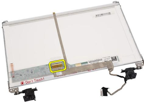
12. Lösen Sie das ganze Bildschirmkabel vom Klebeband, mit dem es am Bildschirm befestigt ist, und entfernen Sie es.
