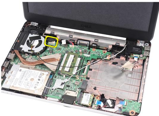
10. Entfernen Sie die Schrauben, mit denen die linken und rechten Scharniere befestigt sind.
