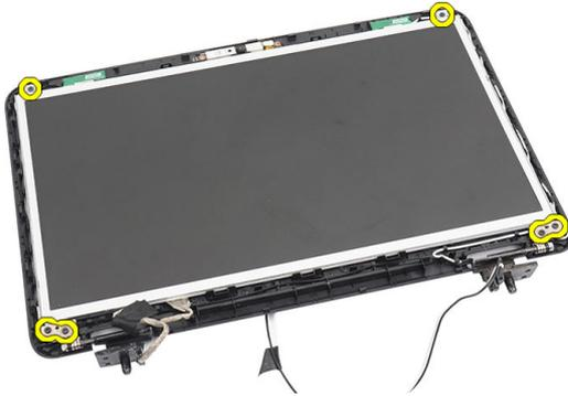
11. Lösen Sie die Wireless-Antennen aus dem rechten Scharnier.
