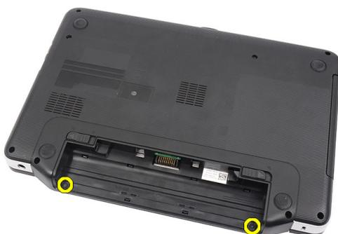
4. Drehen Sie den Computer um und entfernen Sie die Scharnierabdeckung.
