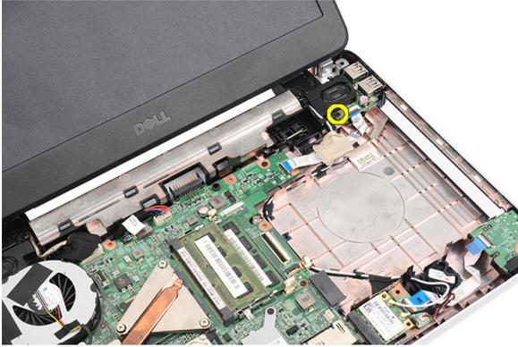
8. Heben Sie die USB-Platine an und entfernen Sie sie aus dem Computer.
