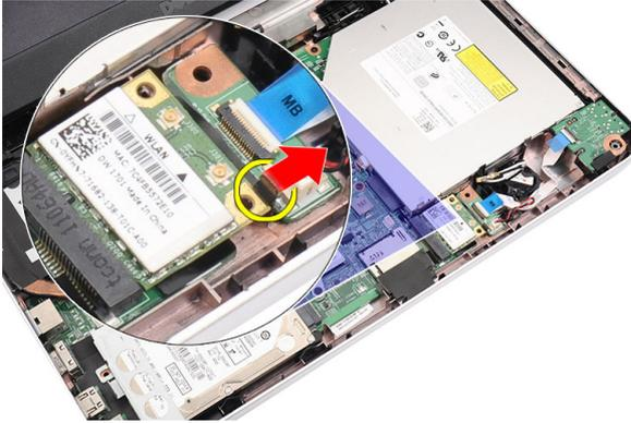
7. Entfernen Sie die WLAN-Karte aus dem Computer.
