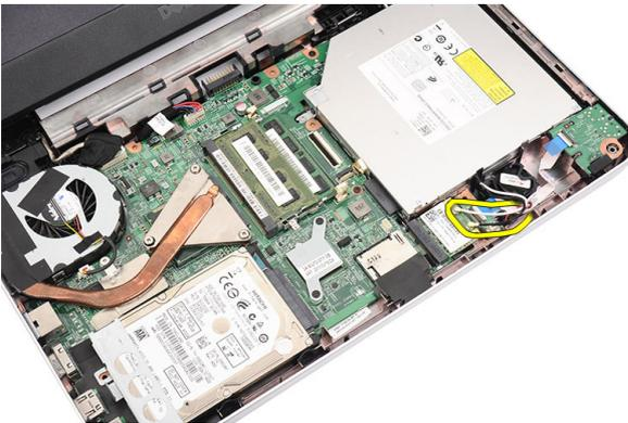
6. Hebeln Sie die Verriegelung nach oben, um die WLAN-Karte aus ihrem Fach zu lösen.
