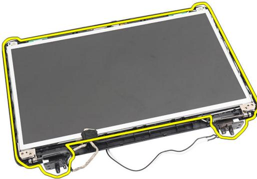
14. Entfernen Sie die Schrauben an den linken und rechten Bildschirmhalterungen und entfernen Sie den Bildschirm.
