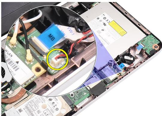
6. Entfernen Sie die Knopfzellenbatterie aus dem Computer.
