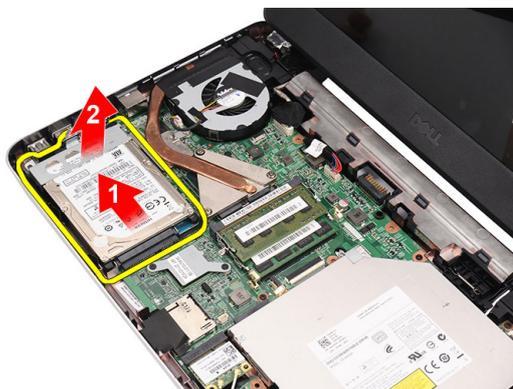
6. Entfernen Sie die Schrauben, mit denen die Festplattenlaufwerkhalterung befestigt ist, und entfernen Sie sie vom Festplattenlaufwerk.
