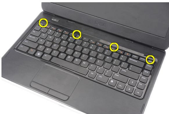
4. Schwenken Sie die Tastatur nach vorn und legen Sie sie auf der Handballenstütze ab.
