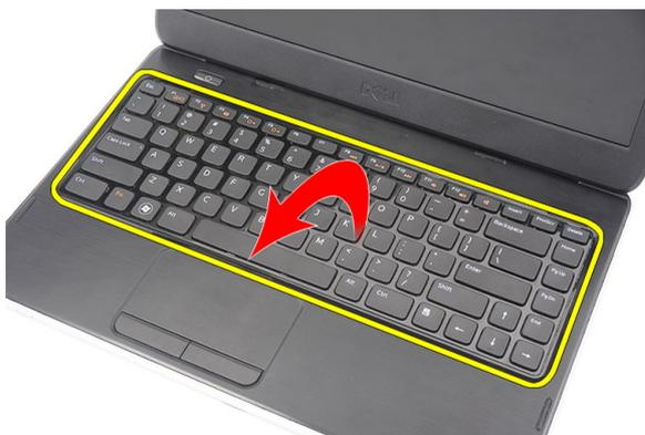
5. Trennen Sie das Tastaturkabel von der Systemplatine.
